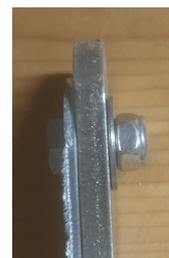
Assemblage d'un tube et d'une tôle
